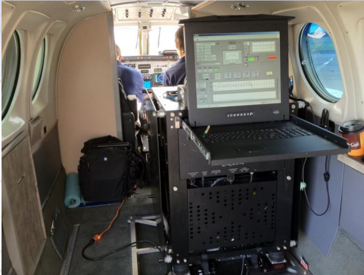
Micro-g LaCoste TAGS Gravimeter
