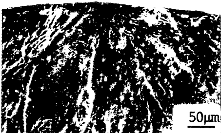
c) Necklace Fine, \sigma_{max}=700 \text{ MPa}
