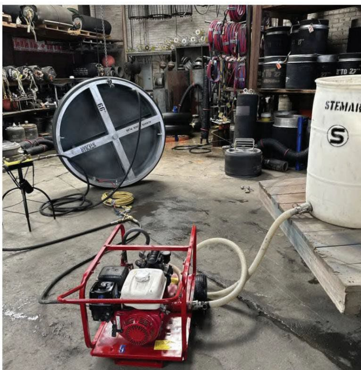
Tapón de prueba de alta presión de 66" configurado para inflado y prueba mediante hidro bomba
