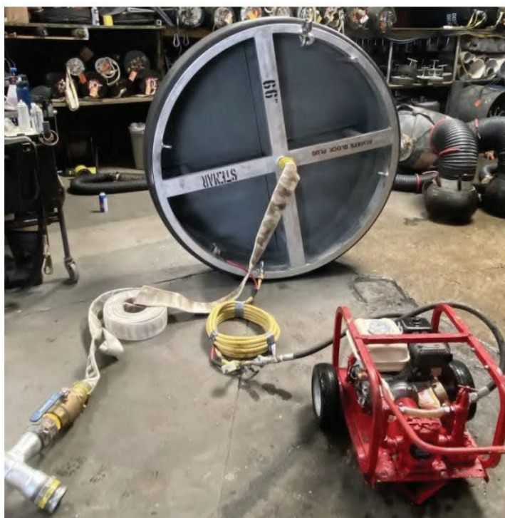
Tapón de prueba de alta presión de 66" configurado para llenado mediante bomba de agua (no se muestra en la imagen) e inflado y prueba mediante hidro bomba
