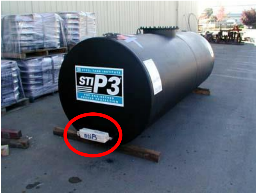
Sacrificial Anode / Galvanic
