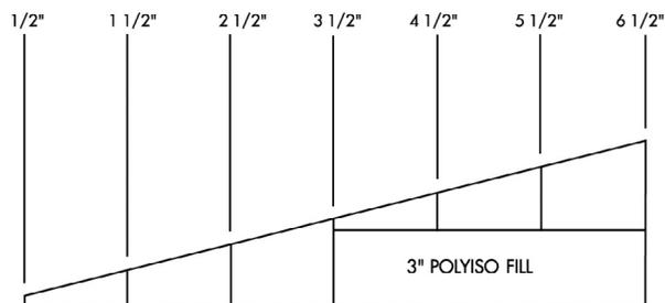
**EXTENDED PANEL: TYPICAL CROSS-SECTION OF 1/4" SLOPE
